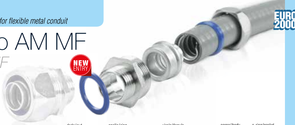
dado/nut anello/ring virola/ferrule corpo/body o-ring/gasket
