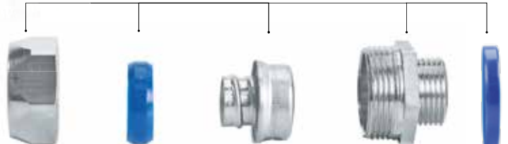
dado/nut anello/ring virola/ferrule corpo/body o-ring/gasket
